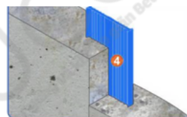
Dùng Băng cản nước PVC kiểu V cho vị trí chính giữa mạch ngừng
